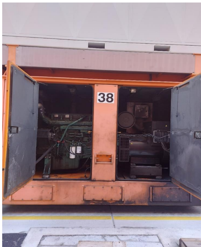
Slika 2: Strojnica RTG 38 (pogonski agregat in generator)
