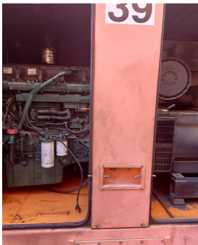
Slika 3: Strojnica RTG 39 (pogonski agregat in generator)
